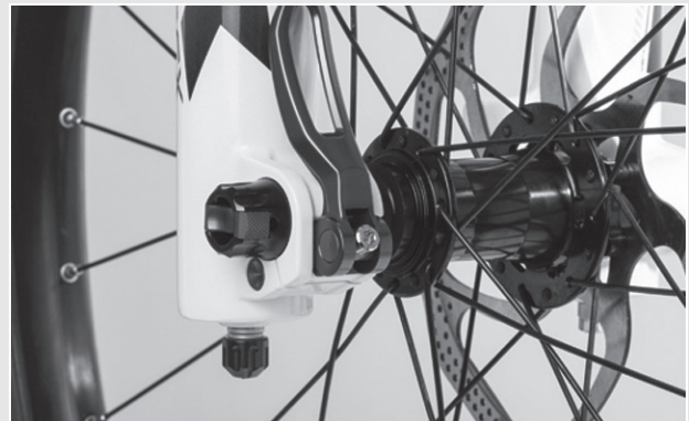
Abbildung 34: Perfekte Lage des Spannhebels
