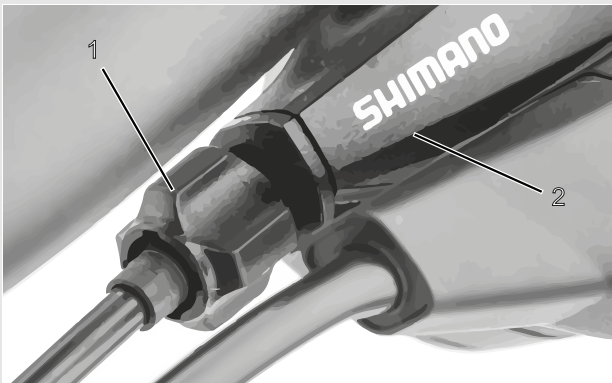
Afbeelding 88: Afstelwartel (1) van de versnelling met enkele bowdenkabelbediening en behuizing van de schakelhendel (2), voorbeeld
