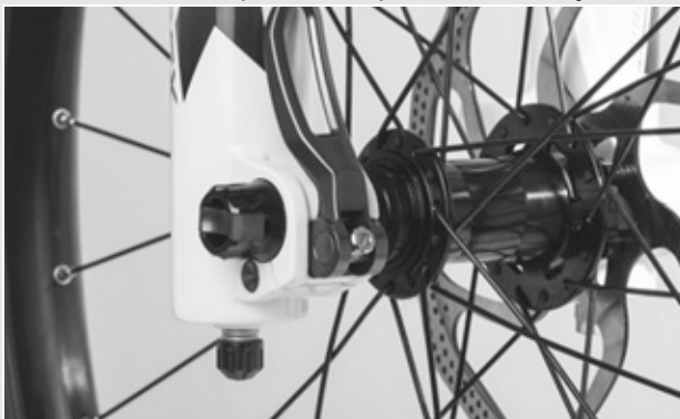
Afbeelding 36: Perfecte stand van de spanhendel
