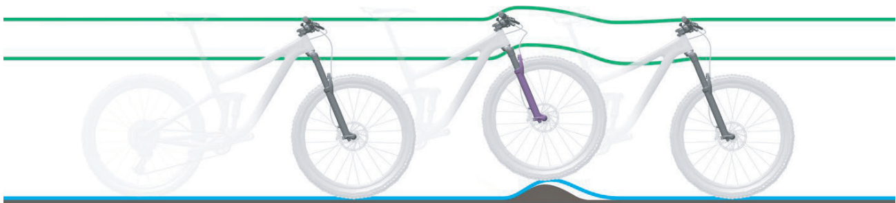
Abbildung 202: Zu harte Dämpfung der Federgabel bei Unebenheiten
