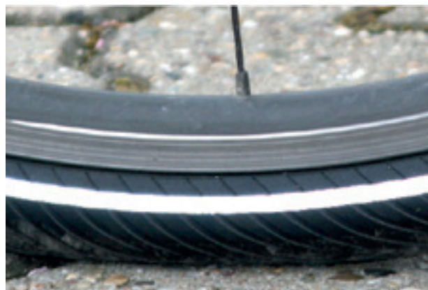
Abbildung 85: Korrekter Fülldruck. Der Reifen ist unter der Last des Körpergewichts kaum verformt.
