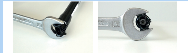
Abbildung 155: Gegen Verdrehen sichern
