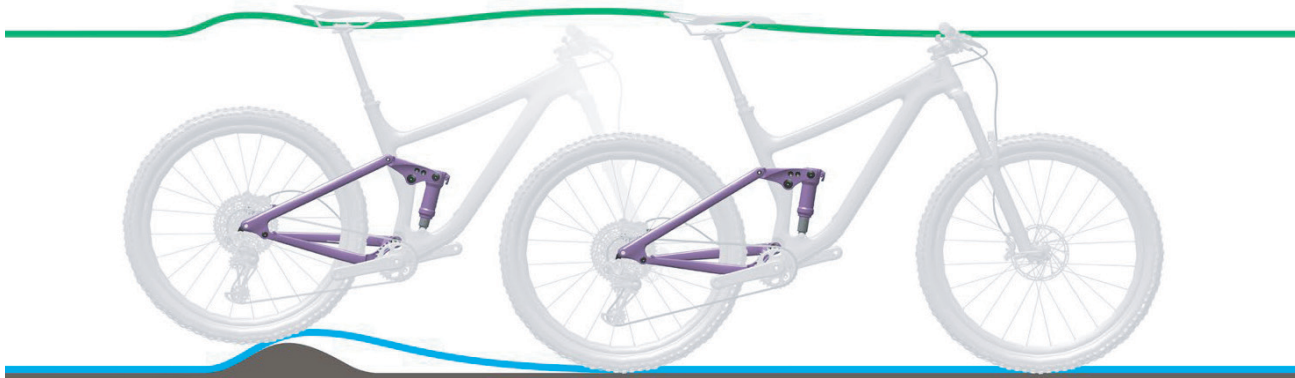
Abbildung 226: Zu harte Dämpfung des Hinterbau-Dämpfers bei Unebenheiten
