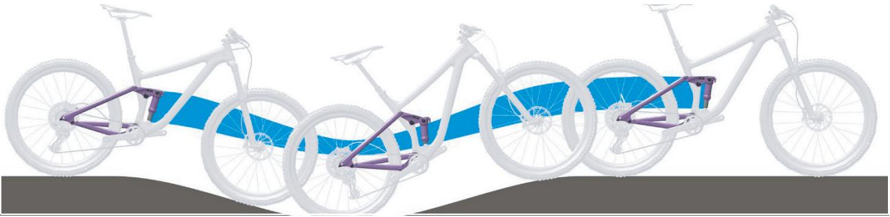
Abbildung 224: Zu weiche Federung des Hinterbau-Dämpfers am Berg
