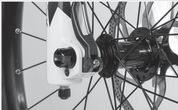
Abbildung 41: Spannkraft des Schnellspanners einstellen
