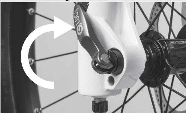
Abbildung 21: Schnellspanner schließen
