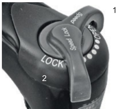
Abbildung 38: Suntour-Druckstufen-Einsteller mit den Positionen OPEN (1) und LOCK (2)
