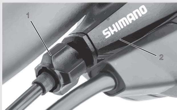
Abbildung 43: Einstellhülse (1) der einzügigen, seilzugbetätigten Gangschaltung mit Schalthebelgehäuse (2), Beispiel
