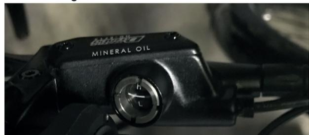
Abbildung 6: Sichtfenster Ölstandskontrolle
