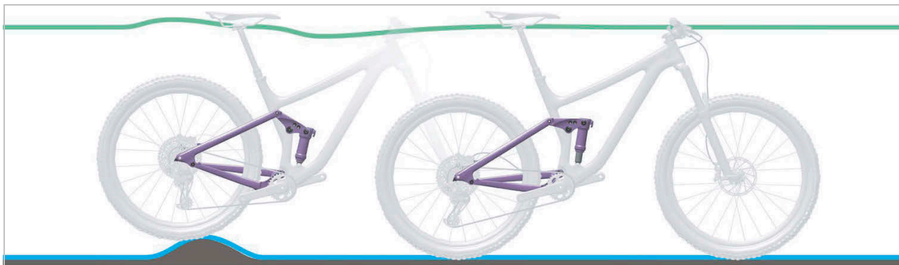
Illustration 127 : Comportement optimal de l'amortisseur arrière sur des irrégularités
