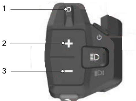
Illustration 135 : Position du bouton à bascule de navigation (1) et des touches Plus (2) et Moins (3)
