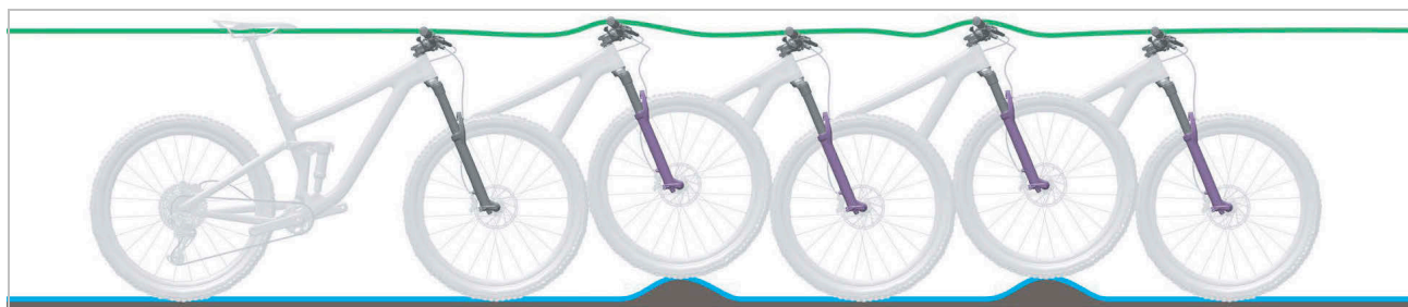
Illustration 18 : Comportement optimal de la fourche de suspension
