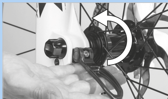
Illustration 80 : Enfoncez le levier d'attache rapide dans le sens de la flèche
