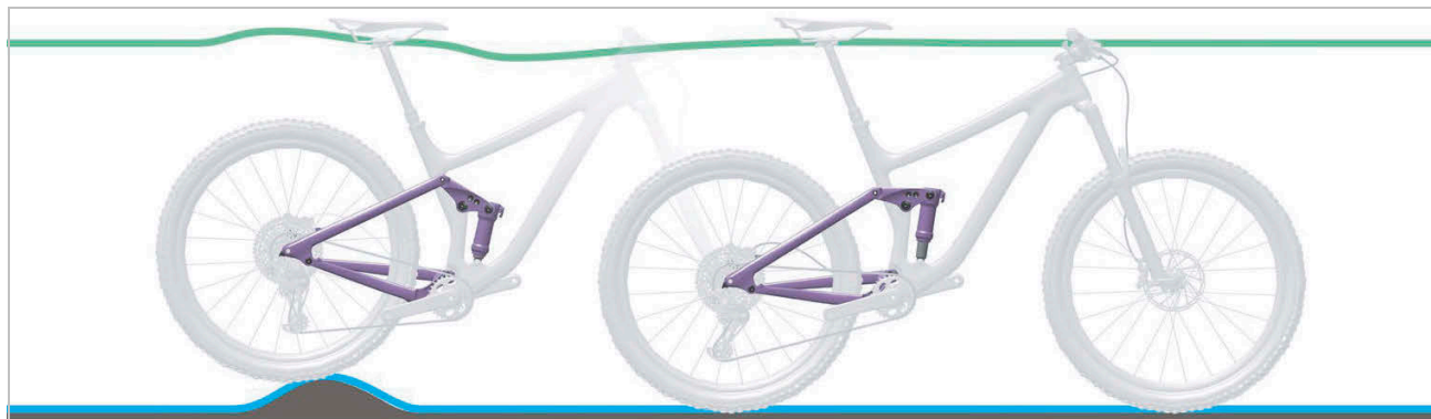
Illustration 155 : Comportement optimal de l'amortisseur arrière sur des irrégularités
