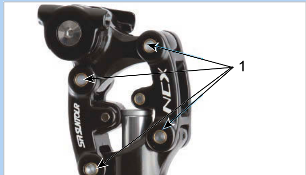
Illustration 196 : Points de lubrification de la tige de selle suspendue SR SUNTOUR
