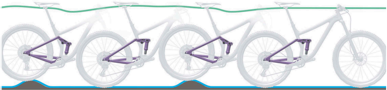
Illustration 8 : Comportement optimal de l'amortisseur arrière
