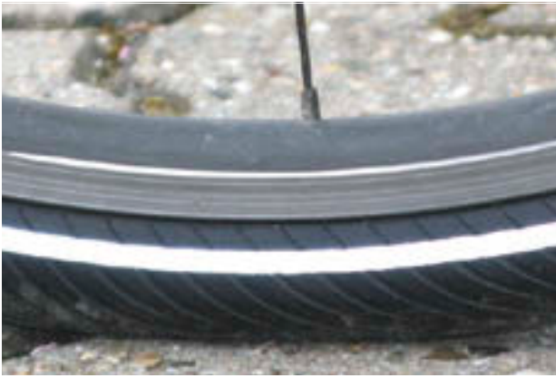
Illustration 113 : Pression correcte. Le pneu se déforme à peine sous le poids du corps.
