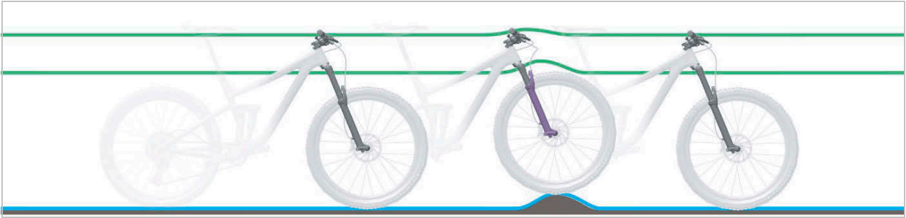
Illustration 20 : Comportement optimal de la fourche de suspension sur les irrégularités
