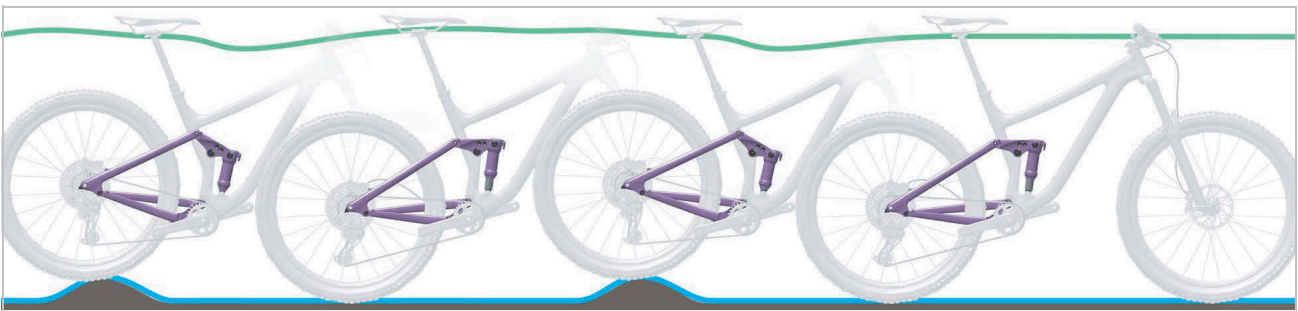
Illustration 7 : Comportement optimal de l'amortisseur arrière
