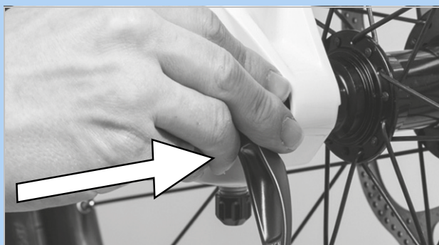
Illustration 84 : Enfoncez l'attache rapide dans le sens de la flèche
