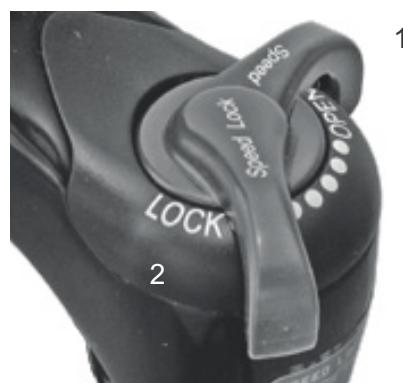
Afbeelding 74: Suntour-drukdemperafsteller met de standen OPEN (1) en LOCK (2)
