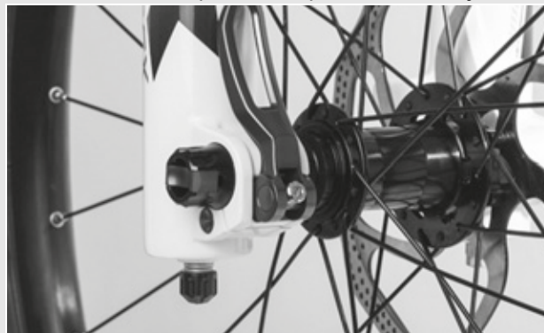
Afbeelding 83: Spankracht van de snelspanner afstellen
