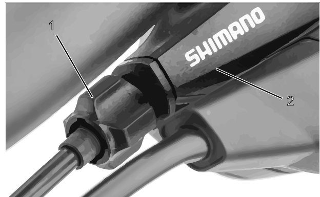
Abbildung 79: Einstellhülse (1) der einzügigen, seilzugbetätigten Gangschaltung mit Schalthebelgehäuse (2), Beispiel
