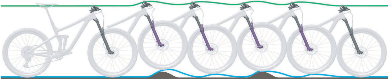
Abbildung 82: Zu schnelles Ausfedern der Federgabel
