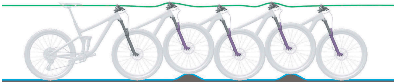
Illustration 15 : Comportement optimal de la fourche
