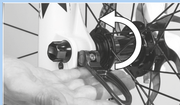
Illustration 88 : Enfoncez le levier d'attache rapide dans le sens de la flèche
