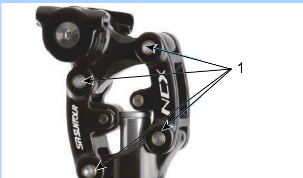
Illustration 218 : Points de lubrification de la tige de selle suspendue SR SUNTOUR
