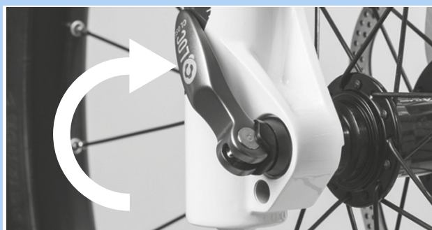
Illustration 94 : Fermer l'attache rapide
