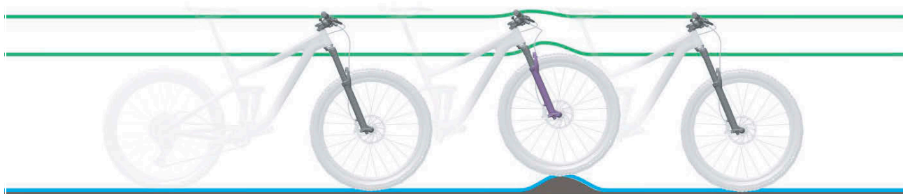
Illustration 134 : Comportement optimal de la fourche sur les irrégularités
