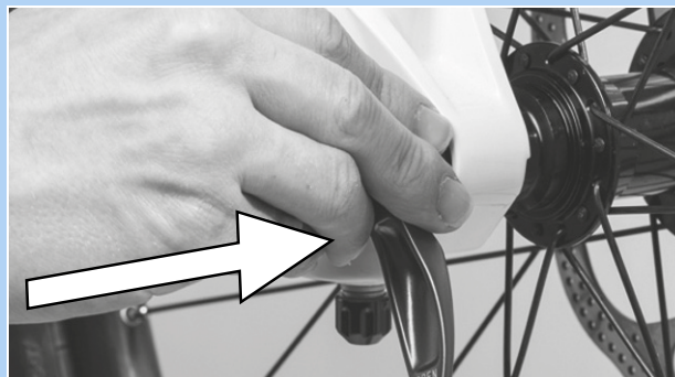
Illustration 92 : Enfoncez l'attache rapide dans le sens de la flèche
