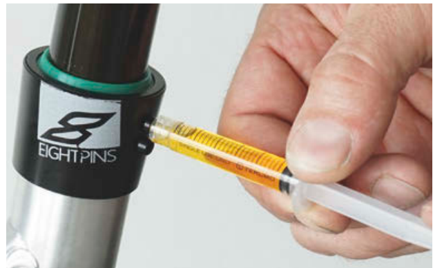
Illustration 184 : Lubrifier une tige de selle eightpins
