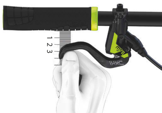
Illustration 129 : Positionnement du frein à main
