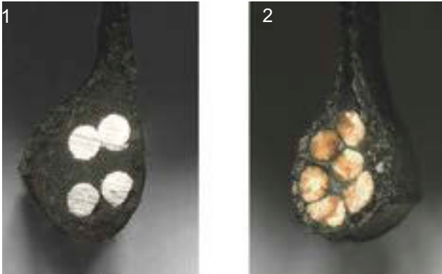
Illustration 25 : tringle en acier (1) et tringle en Kevlar (2)
