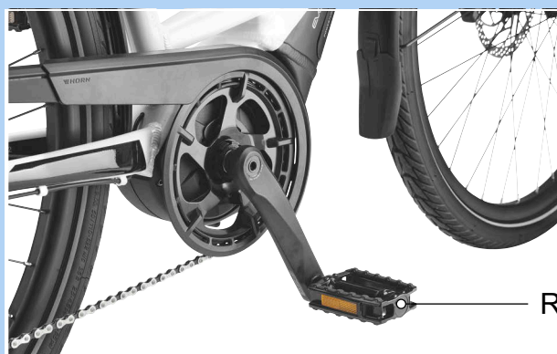
Illustration 99 : Pédale R dans le bras de manivelle droit
