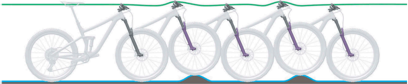
Illustration 12 : Comportement optimal de la fourche
