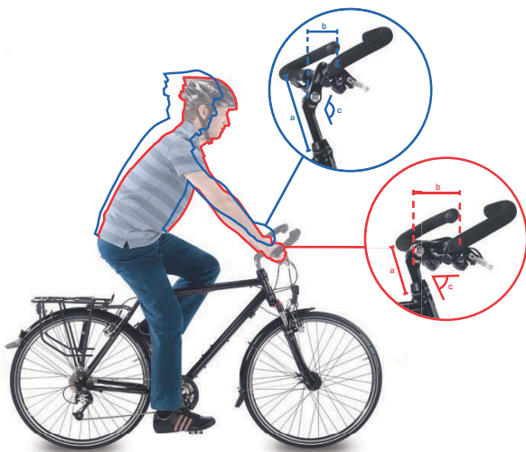
Illustration 122 : Position sur vélo de ville (en bleu) et sur vélo tout chemin (en rouge) avec modification de l'angle
