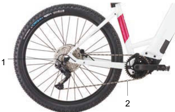
Illustration 45 : Schéma de l'entraînement à chaîne avec dérailleur
