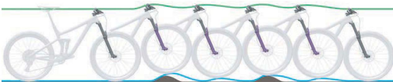
Illustration 220 : Détente trop rapide de la fourche suspendue
