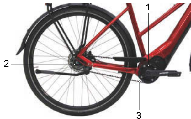
Illustration 46 : Schéma de l'entraînement à courroie
