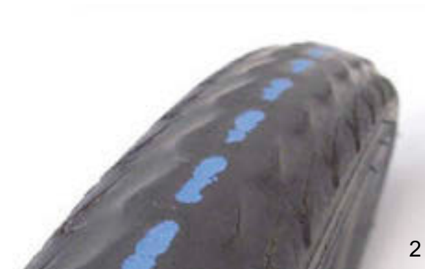
Illustration 186 : Pneu sans profil pouvant être changé (1) et pneu avec protection anti-crevaison visible (2) devant être changé
