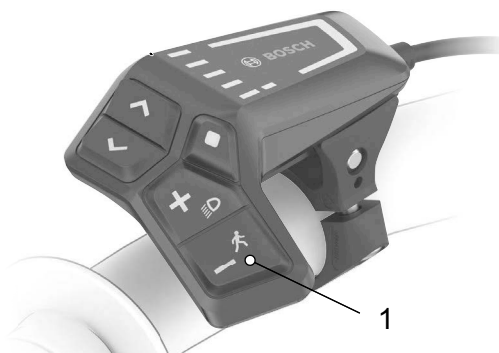
Illustration 173 : Position de la touche d'assistance de poussée (1)
