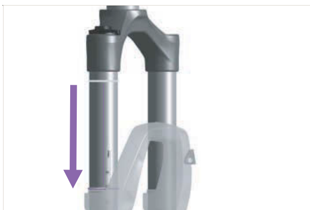
Afbeelding 156: O-ring op de verende voorvork verschuiven
