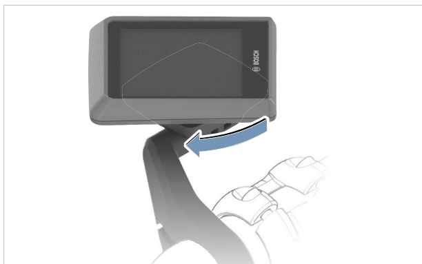
Afbeelding 177: Display rechtsonder draaien
