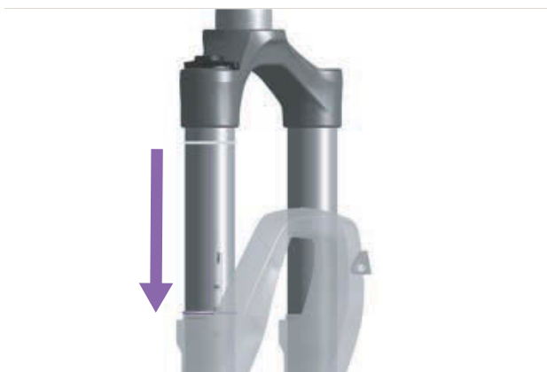
Afbeelding 153: O-ring op de verende voorvork verschuiven
