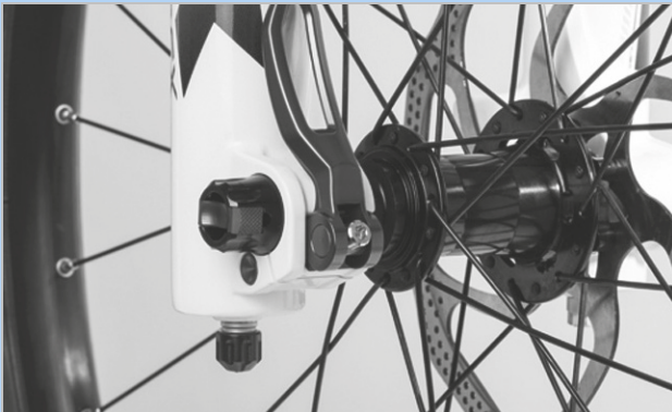
Afbeelding 258: Spankracht van de snelspanner afstellen
