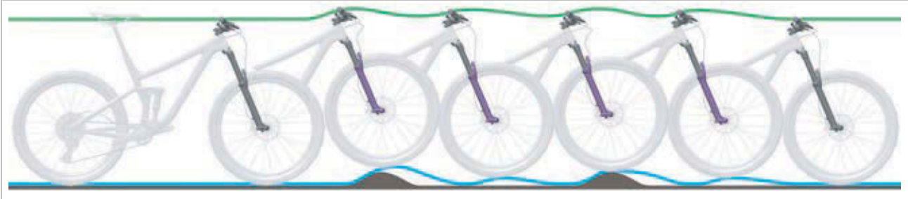
Afbeelding 262: Te snel uitveren van de verende voorvork
