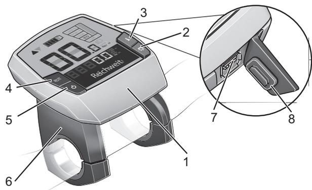
Abbildung 20: Übersicht Aufbau und Bedienelemente des Bildschirms:
