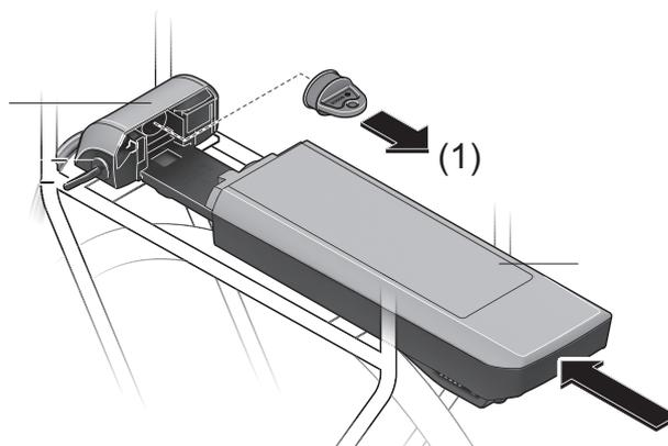
Abbildung 73: Offene Kontakte mit Abdeckklappe abdecken, Beispiel Gepäckträger
