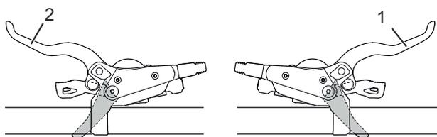
Abbildung 75: Bremshebel hinten (1) und vorne (2), Beispiel Shimano Bremse
