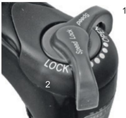
Abbildung 79: Suntour-Druckstufeneinsteller mit den Positionen OPEN (1) und LOCK (2)
