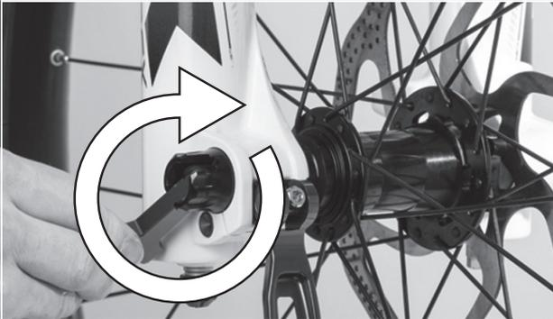
Abbildung 35: Achse anziehen
