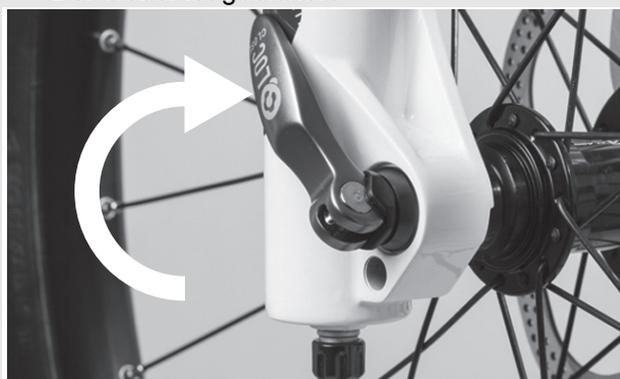
Abbildung 43: Schnellspanner schließen
