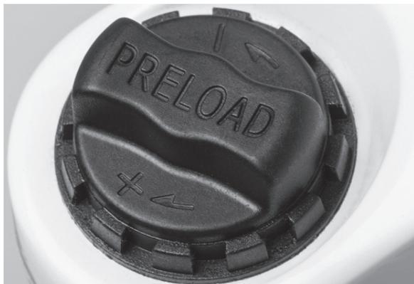
**Abbildung 61:** Einstellrad des Negativen Federwegs auf der Krone der Federgabel
