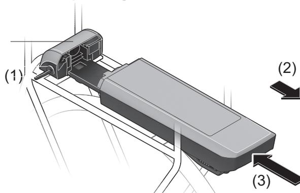
Abbildung 70: Gepäckträgerakku herausnehmen (2) und einsetzen (3)
