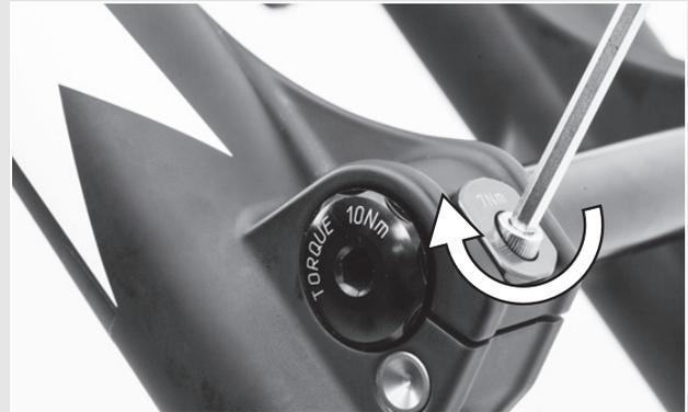
Abbildung 33: Achse anziehen
