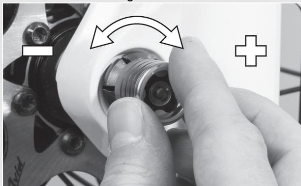
Abbildung 42: Spannung einstellen
