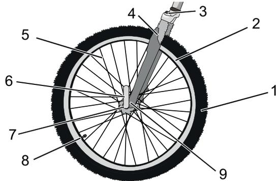
Abbildung 3: Komponenten des Laufrads, Beispiel Vorderrad
