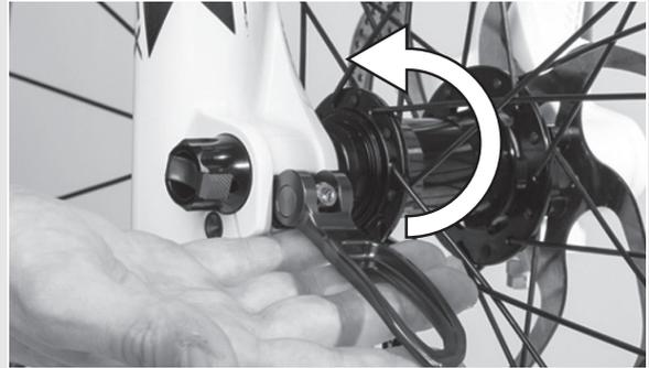
Abbildung 37: Hebel sichern
