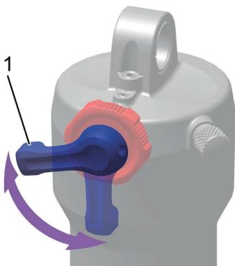
Abbildung 83: Härte des Druckstufen-Dämpfers am Hebel (1) des Hinterbau-Dämpfers einstellen
