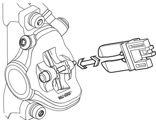
Abbildung 27: Transportsicherung befestigen
