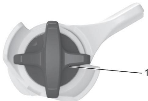
Abbildung 67: FOX-Zugstufeneinsteller (1) am Hinterbau-Dämpfer
