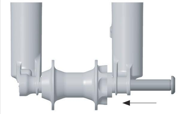
Abbildung 47: Kabolt-Achse einschieben
