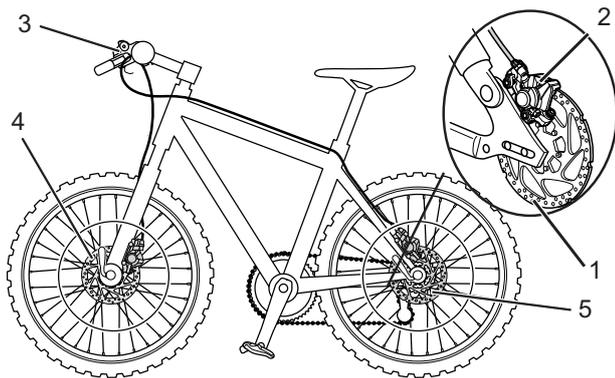
Abbildung 11: Bremssystem eines Pedelecs mit einer Scheibenbremse, Beispiel
