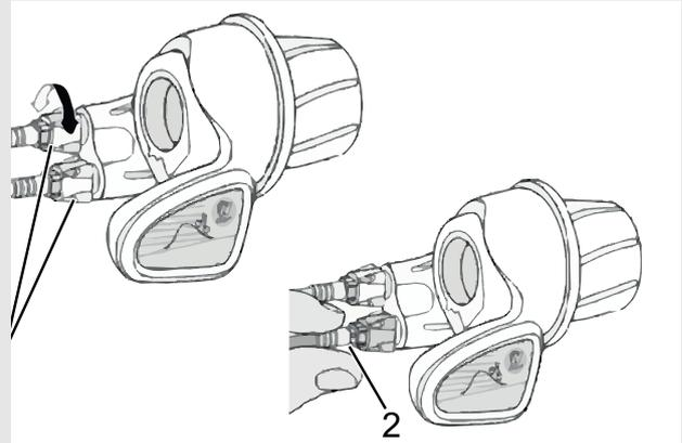
Abbildung 91: Drehgriffschalter mit Einstellhülsen (1) und Spiel der Gangschaltung (2).
