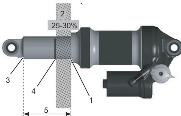
Abbildung 66: FOX-Hinterbau-Dämpfer:
