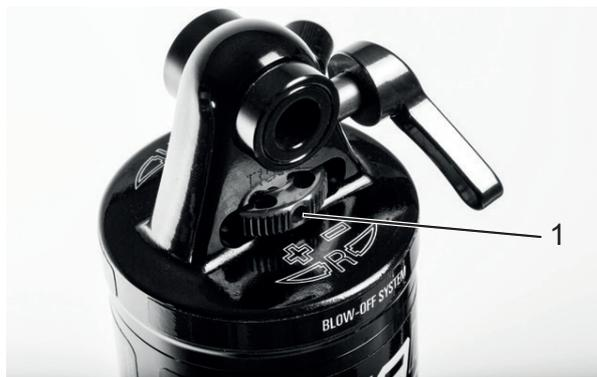
Abbildung 64: Suntour-Zugstufeneinsteller Rad(1) am Hinterbau-Dämpfer
