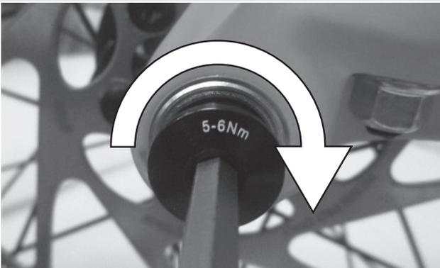
Abbildung 31: Sicherungsschraube anziehen
