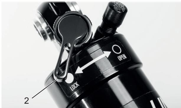
Abbildung 81: Suntour-Druckstufeneinsteller geschlossen (2))
