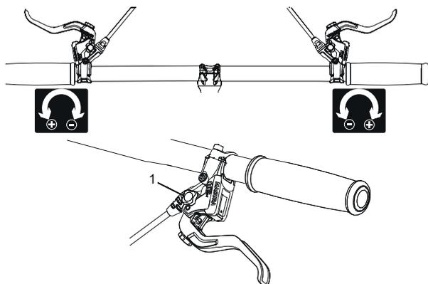
Abbildung 56: Benutzung des Drehknopfs (1) zur Druckpunkt-Einstellung
