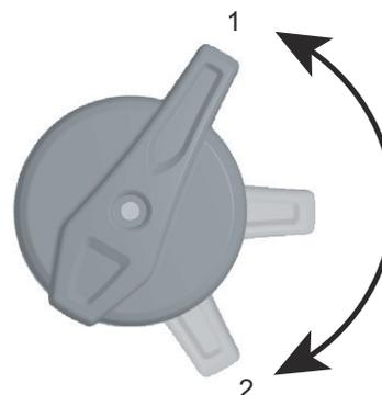
Abbildung 76: FOX-Druckstufeneinsteller mit den Positionen OFFEN (1) und HART (2)
