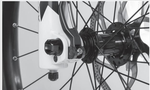
Abbildung 38: Perfekte Lage des Spannhebels
