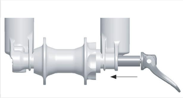
Abbildung 44: Schnellspanner einschieben
