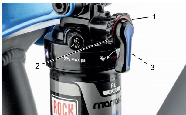
Abbildung 82: Härte des Zugstufen-Dämpfers am Einstellrad (1) des Hinterbau-Dämpfer einstellen
