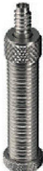
Der Fülldruck kann beim einfachen Blitzventil nicht gemessen werden. Daher wird der Fülldruck im Füllschlauch bei langsamen Pumpen mit der Pedelecluftpumpe gemessen.
