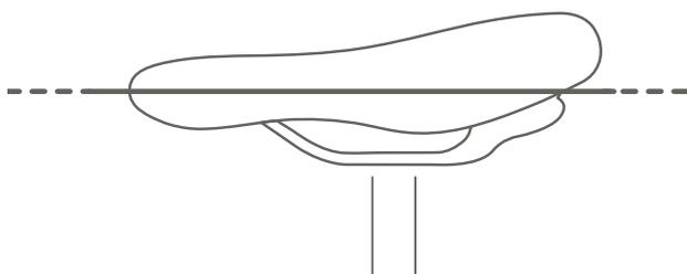
Abbildung 48: Waagerechte Sattelneigung
