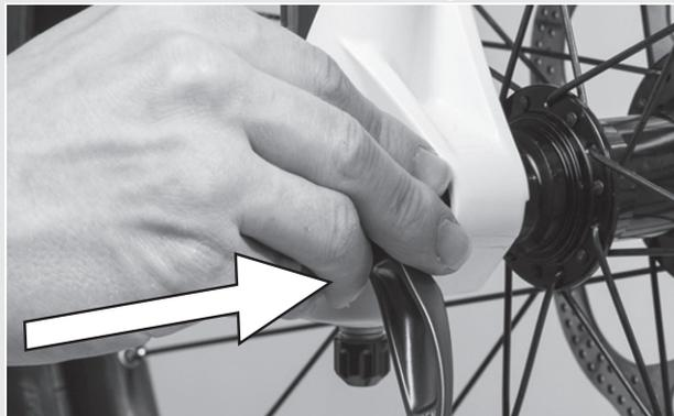
Abbildung 41: Schnellspanner hineinschieben
