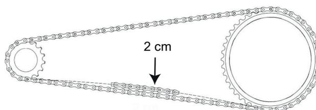
Abbildung 86: Kettenspannung prüfen
