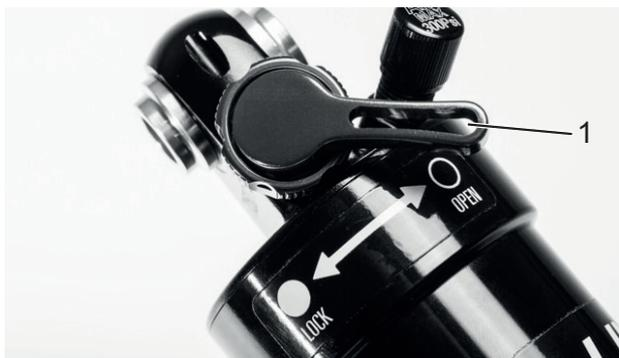
Abbildung 80: Suntour-Druckstufeneinsteller geöffnet (1)
