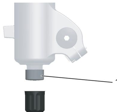
**Abbildung 63:** FOX-Zugstufeneinsteller (1) an der Gabel
