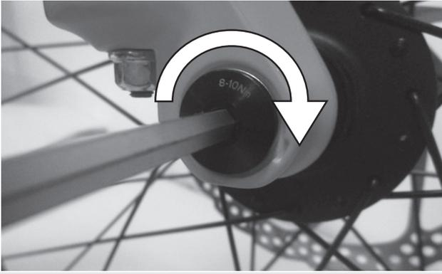
Abbildung 29: Achse anziehen
