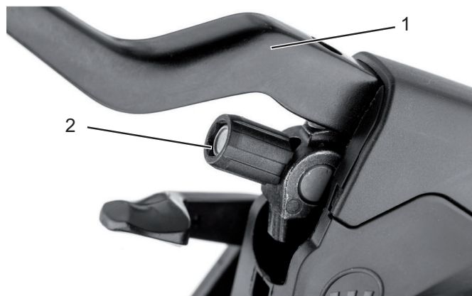
Afbeelding 64: Remhendel (1) van de hydraulisch bediende velgrem met afstelschroef (2)
