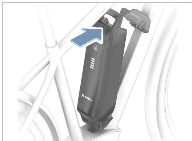
Afbeelding 142: PowerPack accu omhoog klappen
