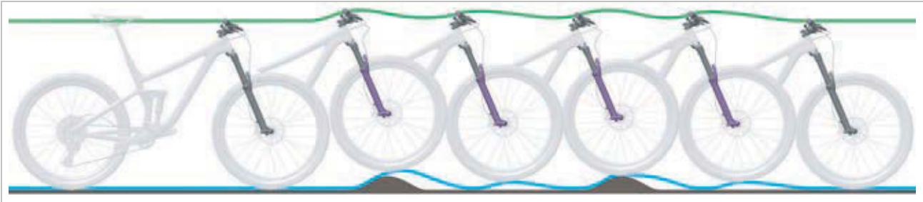
Afbeelding 206: Te snel uitveren van de verende voorvork
