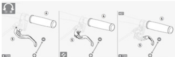
Figura 19: Ajustar el ancho de agarre de la palanca de freno con freno de disco Magura
