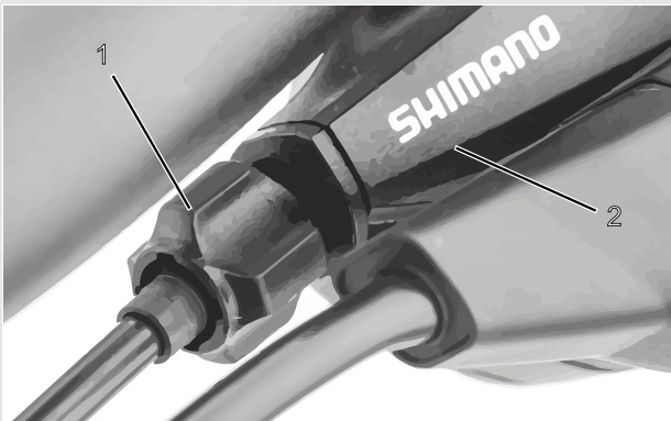
Figura 35: Casquillo de ajuste (1) del cambio de marchas accionado por cable de accionamiento con carcasa de la palanca de cambio (2), ejemplo
