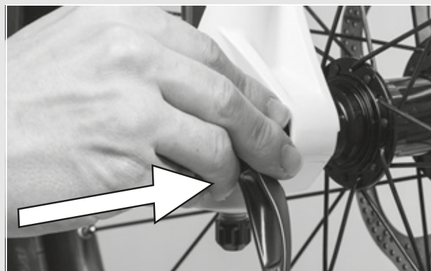
Figur 49: Skub hurtigbespændingen ind
