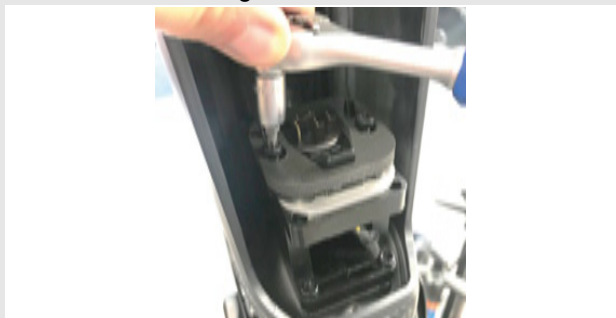
Figur 23: Løsne skruer på batteriholder
