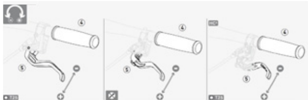
Figur 63: Indstilling af grebsbredden på Magura skivebremse bremsegreb
