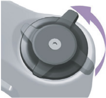
Figur 100: Blødere indstilling på trykindstillingsanordning
