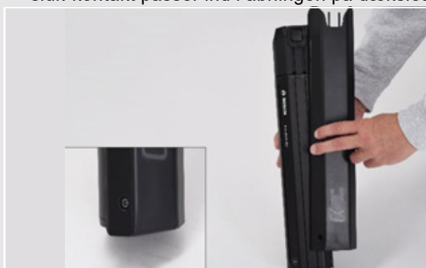
Figur 35: Skub batteridækslet på batteriet
