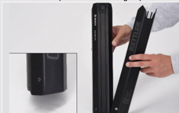
Figur 31: Skub batteridækslet på batteriet
