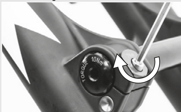
Figur 41: Tilspænding af sikringsklemme
