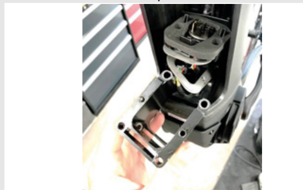
Figur 26: Træk PowerTube-adapteren ud
