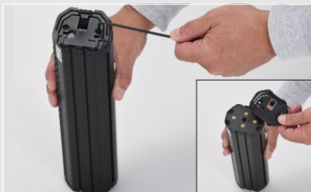
Figur 32: Afmontering af den øverste grænseflade
