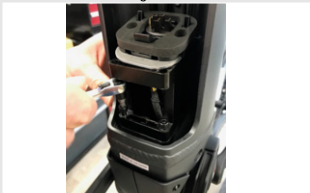
Figur 24: Fjernelse af 4 mm 6-kant-skruer
