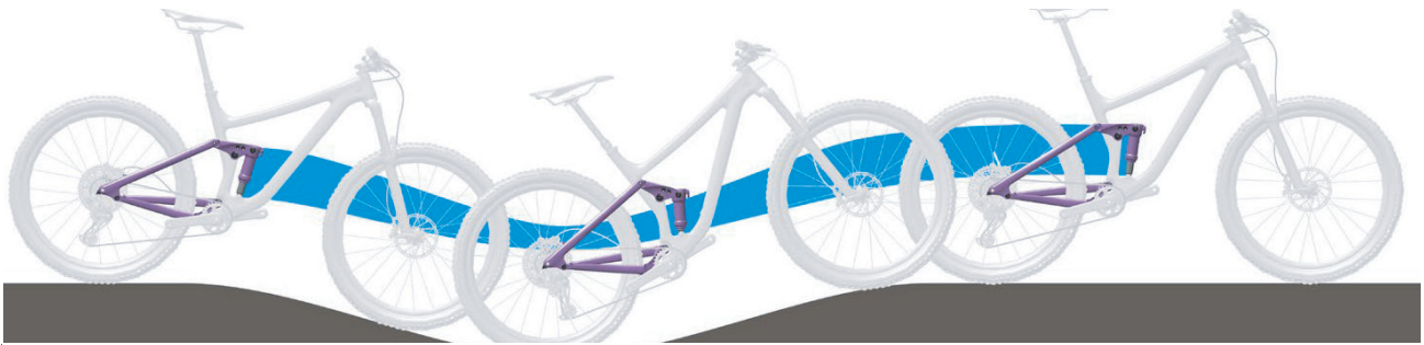
Abbildung 296: Zu weiche Federung des Hinterbau-Dämpfers am Berg
