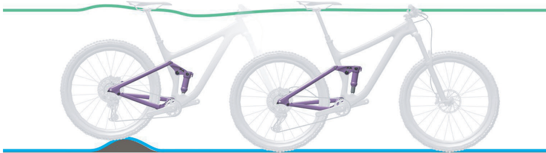
Abbildung 36: Optimales Fahrverhalten des Hinterbau-Dämpfers bei Unebenheiten
