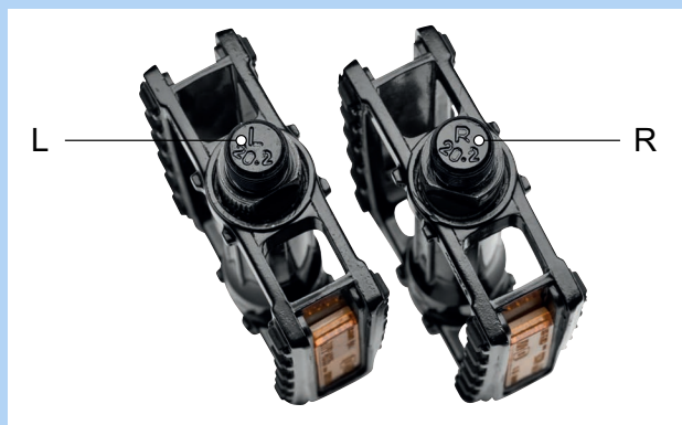
Abbildung 91: Beispiel Kennzeichnung von Pedalen
