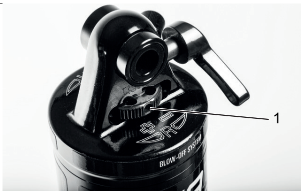
Abbildung 287: Suntour-Zugstufeneinsteller Rad (1) am Hinterbau-Dämpfer
