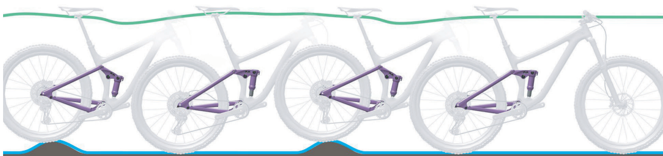
Abbildung 37: Optimales Fahrverhalten des Hinterbau-Dämpfers
