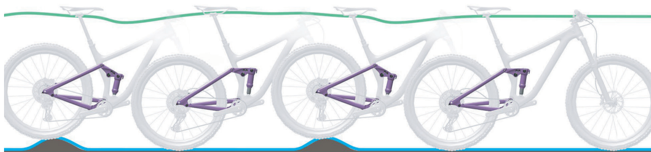
Abbildung 34: Optimales Fahrverhalten des Hinterbau-Dämpfers
