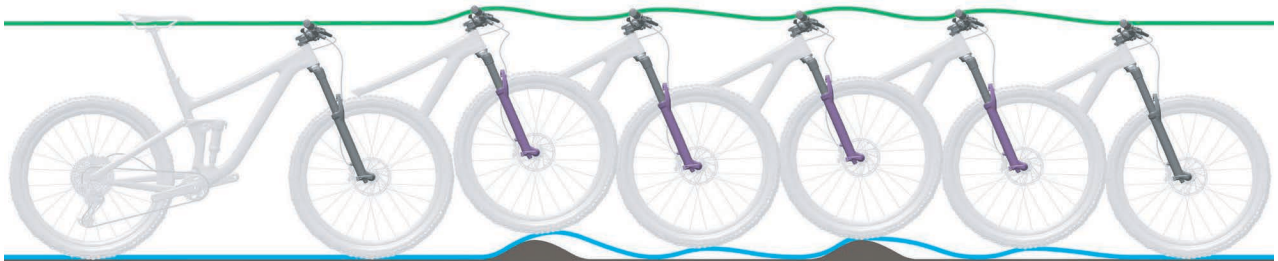
Abbildung 268: Zu schnelles Ausfedern der Federgabel
