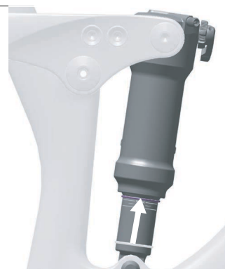
Abbildung 144: O-Ring am Hinterbau-Dämpfer verschieben
