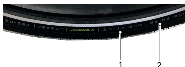
Abbildung 193: Fülldruck in bar (1) und psi (2)
