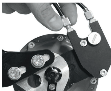
Abbildung 200: ROHLOFF-Naben Versionen mit externer Schaltansteuerung haben die Zugeinsteller an der Seilbox, die sich auf der linken Seite befindet
