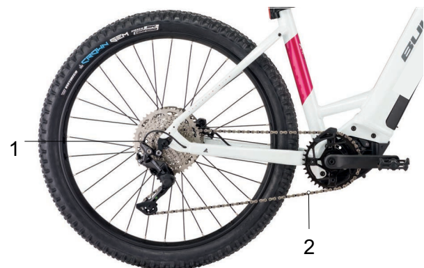
Abbildung 21: Schema Kettenantrieb mit Kettenschaltung
