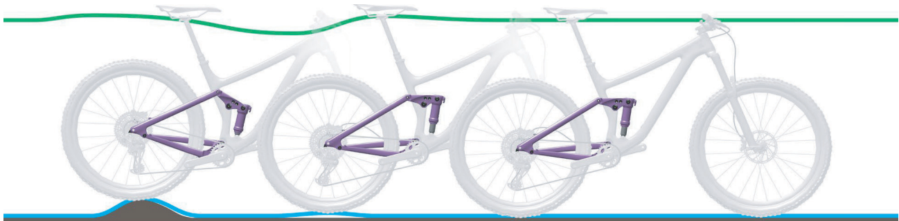
Abbildung 292: Zu schnelles Ausfedern des Hinterbau-Dämpfers
