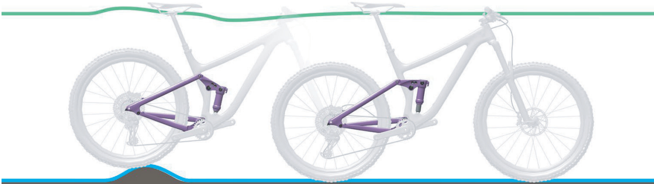
Abbildung 150: Optimales Fahrverhalten des Hinterbau-Dämpfers bei Unebenheiten
