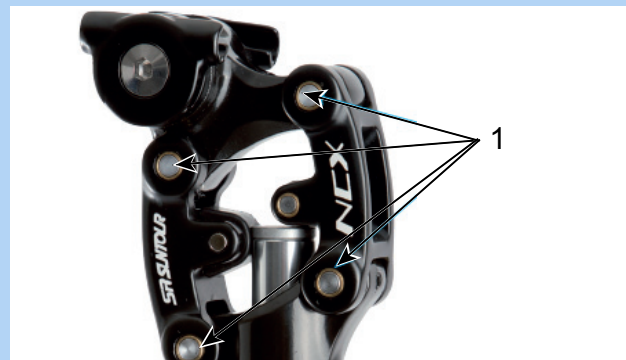
Abbildung 205: Schmierpunkte SR Suntour Feder-Sattelstütze
