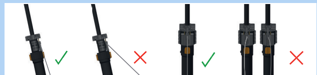
Abbildung 233: Korrekter und falscher Bowdenzug
