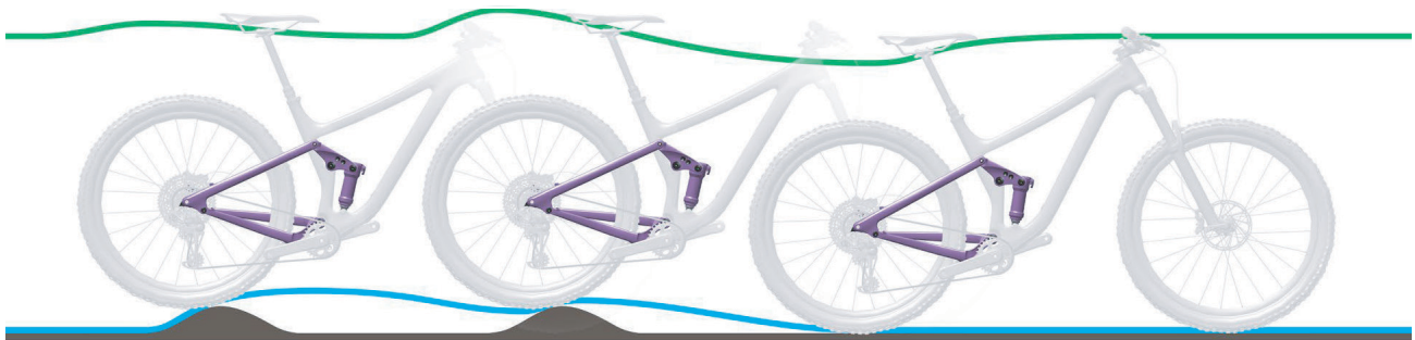
Abbildung 286: Zu langsames Ausfedern des Hinterbau-Dämpfers
