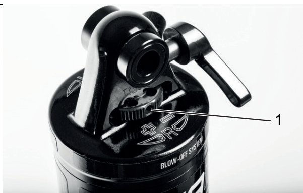
Abbildung 285: Suntour-Zugstufeneinsteller Rad (1) am Hinterbau-Dämpfer
