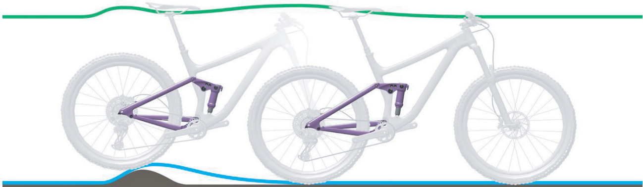
Abbildung 298: Zu harte Dämpfung des Hinterbau-Dämpfers bei Unebenheiten
